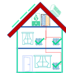
Woning met waterstofketel en kleine warmtepomp (hybride oplossing)
